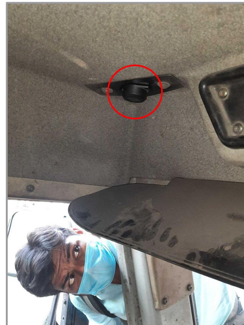
BLE Beacon inside HEMM
